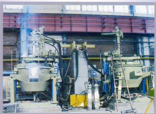
Плавильный агрегат ДППТУ-0,5 АГ емкостью: 0,5-0,8 т по Al; 0,5-1,2 т по стали и чугуна; 0,5-1,5 т сплавы на основе меди; 0,5-1 т для переработки свинцово-содержащих отходов. ОАО «Ступинская металлургическая компания»
