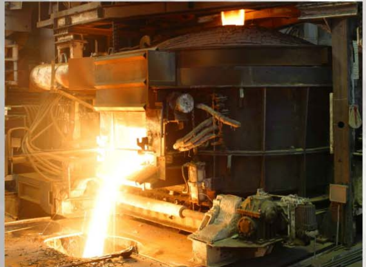
ДППТУ-6. ОАО "Металлургический завод "Электросталь"
