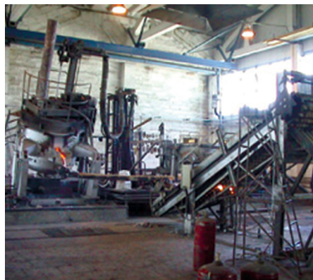
Рис.1 б). Печной агрегат ДППТУ-0,5АГ (Эстония). Плавка алюминия
