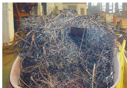
Рис. 9. Пример переплавляемой шихты (стружка с высоким содержанием СОЖ и масел).
