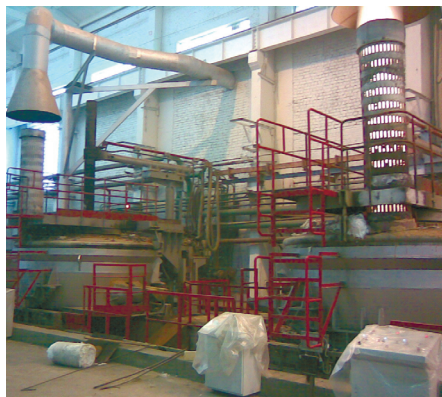
Рис.1 а). Печной агрегат ДППТУ-6АГ. Переплав шлаковых отходов и алюминиевой стружки.
