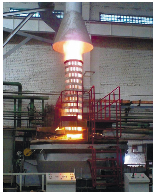
Рис 10. Плавка металлов в ДППТУ-НП с организованным дожиганием отходящих газов при плавке сильно загрязненной шихты (Рис. 9).
