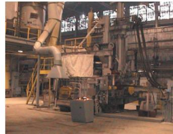
ДППТУ-12. ОАО «ГАЗ», г. Нижний Новгород. Выплавка синтетического чугуна и сталей для автомобильной промышленности
