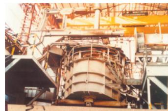
ДППТУ-24. Elektrotherm, Индия. Производство безникелевых нержавеющей сталей. Основная шихта - металлургические окатыши.
