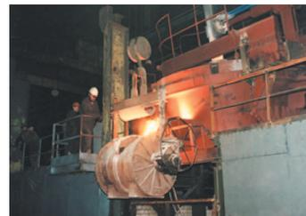
ДППТУ-ЗАГ. ОАО «Мотордеталь», г. Кострома. Используется для безотходного переплава 100% чугунной стружки.
