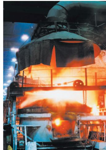
ДППТУ-6АГ. ОАО «Курганмашзавод» (реконструкция ДСП-5). Производство стали типа 110Г13Л, ХМЛ, 1Х18Н10Т, специальных и высокопрочных чугунов.
