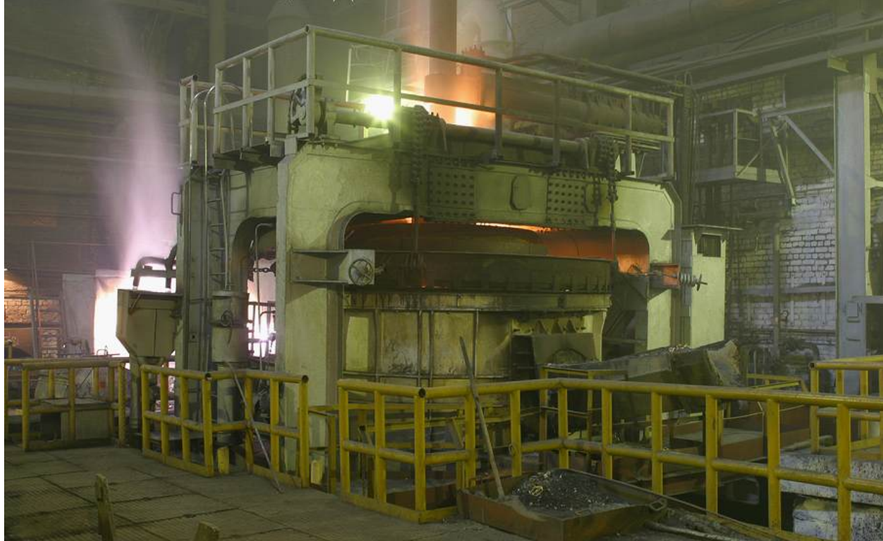
ОАО "ТЯЖПРЕССМАШ" г.РЯЗАНЬ. Дуговая печь постоянного тока вместимостью 25 т для выплавки стали, выполненная пере- водом ДСП на постоянный ток.
