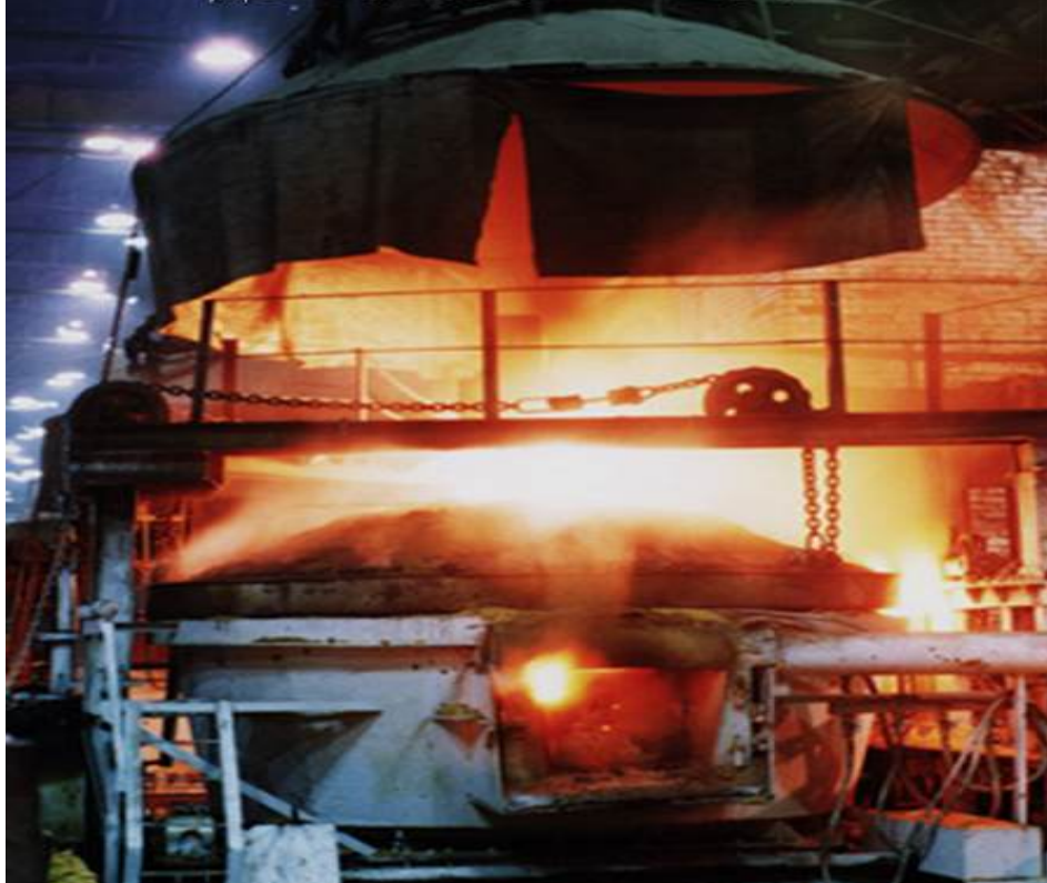
ОАО "ТЯЖПРЕССМАШ" г.РЯЗАНЬ. Дуговая печь постоянного тока вместимостью 25 т для выплавки стали, выполненная пере- водом ДСП на постоянный ток.
