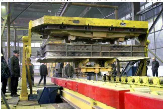
Формовка балки надрессорной на ФМ 22507
