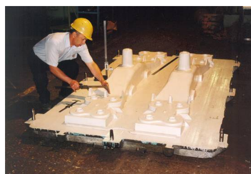
Модель «верха» отливки «рама боковая» с подмодельной плитой
