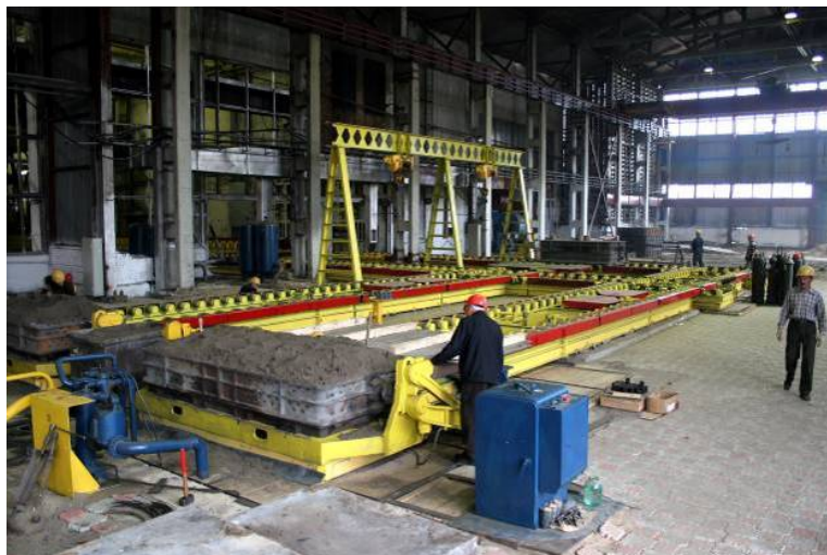
Участок формовки и сборки форм (формовочные машины модели 22507 с роликовым конвейером)
