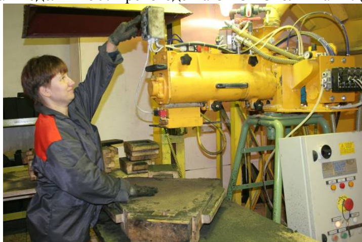
Изготовление стержней на смесителе непрерывного действия модели Т36/3 фирмы "IMF" (Италия).
