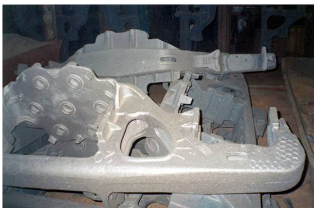
Отливки «рама боковая» после термической и дробеметной обработок
