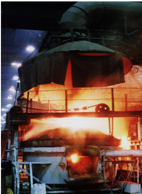
Рис. 2. Рудный кип в ДППТУ-НП. (На фото: плавка в ДППТУ-6, ОАО «КУРГАНМАШЗАВОД»)
