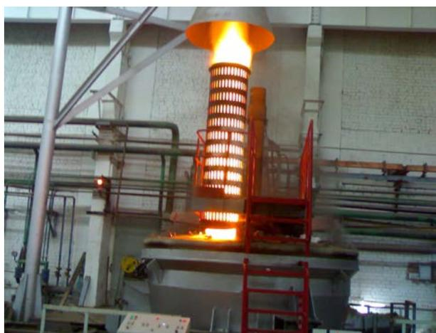
Рис. 3. Плавка металлов в ДППТУ-НП с организованным дожиганием отходящих газов при плавке сильно загрязненной шихты (фото 4). (На фото: печной агрегат ДППТУ-6АГ, г.Сухой Лог)
