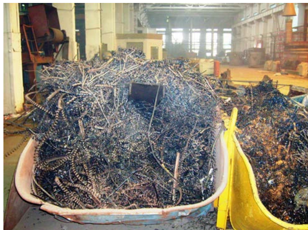
Рис. 4. Пример переплавляемой шихты в ДППТУ-НП (стружка с высоким содержанием СОЖ и масел).
